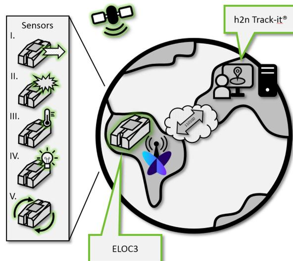
Um eine möglichst genaue Verfolgung zu gewährleisten, wartet das Gerät, bis mindestens 5 Satelliten erreicht sind. Wird dieser Zustand nach maximal 40 Sekunden nicht erreicht, wird der Wartevorgang abgebrochen und die zuvor bestimmte Position, auch wenn sie ungenau ist, verwendet. Kann keine Positionierung durchgeführt werden, wird ein "NO FIX"-Telegramm gesendet, das in der h2n Track-it® Cloud angezeigt werden kann.
