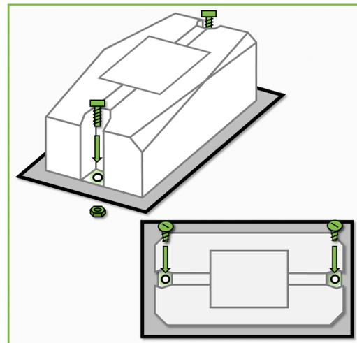
Anbringen zu vermeiden. Achten Sie auch darauf, dass die Bohrungen gereinigt werden und keine Unebenheiten entstanden sind. Verwenden Sie für die Befestigung zwei Schrauben M4, siehe A). Die Schrauben durch die vorgesehenen Löcher stecken und mit einer Mutter befestigen, siehe D).
