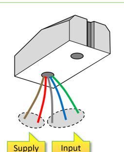
Alle Geräte mit externer Versorgung verfügen auch über interne Batterien, um den Betrieb zu gewährleisten, wenn keine externe Versorgung vorhanden ist. Verschiedene Betriebsprofile sind aktiv, wenn eine externe Stromversorgung vorhanden ist oder wenn sie nur mit internen Batterien betrieben werden.
