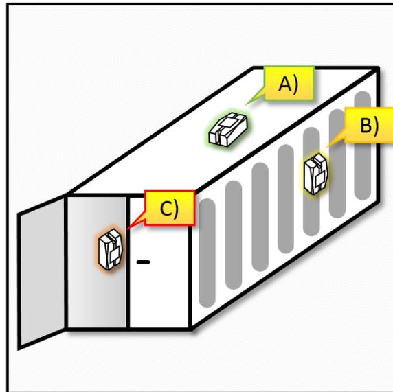
Im Idealfall sollte die EL3CT1 so montiert werden, dass sie nicht aus dem Behälter ragt, um mechanische Beschädigungen zu vermeiden. Für einen Schiffscontainer ergeben sich daraus die folgenden Möglichkeiten für eine sichere Befestigung:
