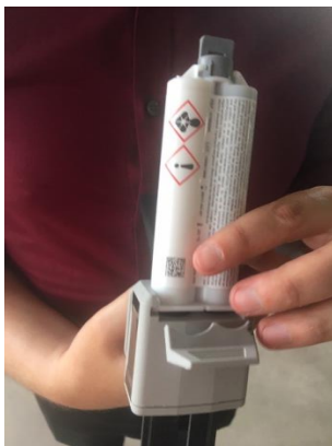
Εικόνα 7 Τοποθέτηση του φυσιγγίου
