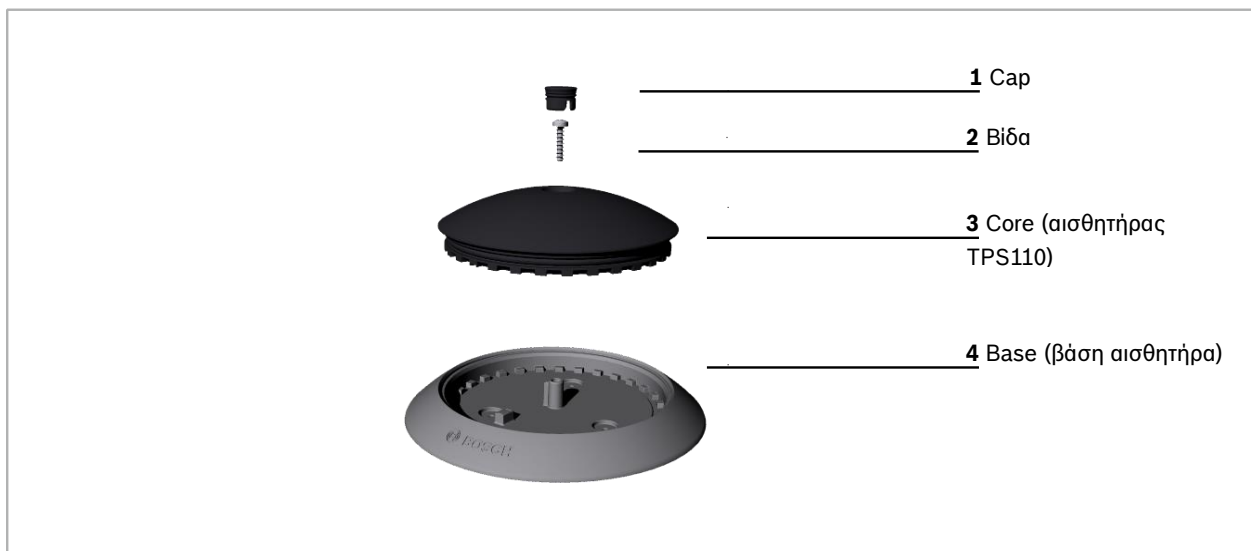
Εικόνα 1 Αισθητήρας Parking Lot PLS με αισθητήρα TPS110
