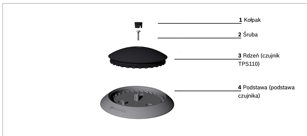
Rys. 1 Czujnik miejsc parkingowych Parking Lot Sensor (PLS) z rdzeniem czujnika TPS110
