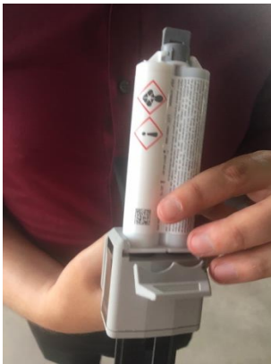
Abbildung 7 Einlegen der Kartusche
