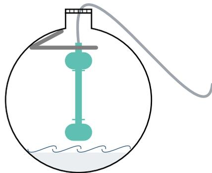
Le capteur double niveau est fait d'acier inoxydable 304 donc pour tous types de fluides non corrosifs, il peut supporter une température maximale de 120°C et une pression maximale de 5MPa (=50 bars).
